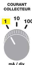
Figure 4: Pour tester des transistors de moyenne puissance, il faut mettre le bouton du Courant de collecteur sur 10 mA/div.
