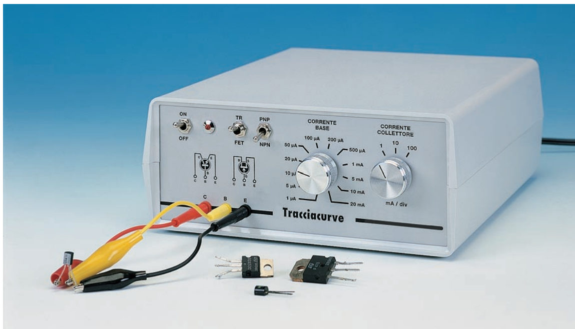
Figure 1: Photo de l'appareil complet dans son boîtier plastique. Les pattes du transistor, du FET, d'un thyristor ou d'un triac, saisies par la pince croco, sont reliées par des fiches bananes aux douilles CBE.
